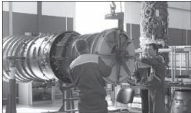
Экскурсия началась с цеха механической обработки и ремонта, куда «сердце» самолета попадает для того, чтобы специалист определил степень его повреждения и затем, назначив вид ремонта, направил в следующий цех — на участок
